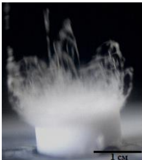
Рис. 4. Образование «короны» из волокон ПТФЭ при воздействии на блок излучения лазера мощностью 30-40 Вт
