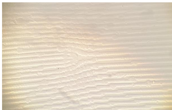
Рис. 2. Рельефно-фазовая реплика металлизированной маски для формирования вихревых лазерных пучков
