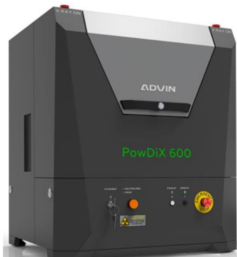
Рис. 1. Рентгеновский порошковый дифрактометр PowDiX 600
