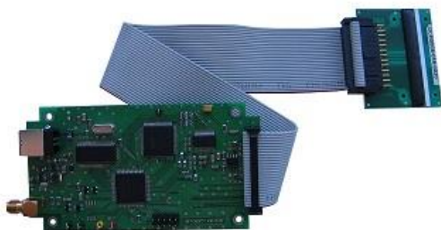
Рис. 3. Внешний вид рентгеновской линейки X-Card 0.2-256G с управляющим контроллером
