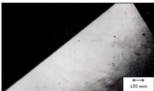
Рис. 2. Момент прекращения генерации одиночных ступеней роста на грани (101) кристалла \alpha -LiJO 3
