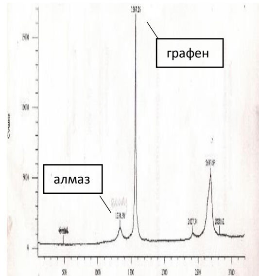
Рис. 1. Спектр комбинационного рассеяния после обработки пирографита лазерным излучением
