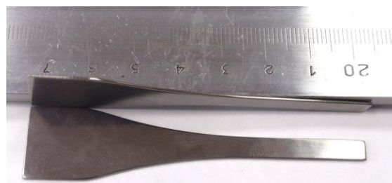
Рис. 1. Внешний вид усталостных образцов с острыми кромками из сплава ВТ18У
