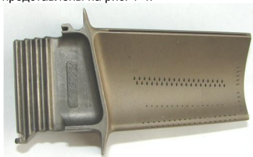
Рис. 1. Внешний вид лопатки ТВД с перфорационными отверстиями.
