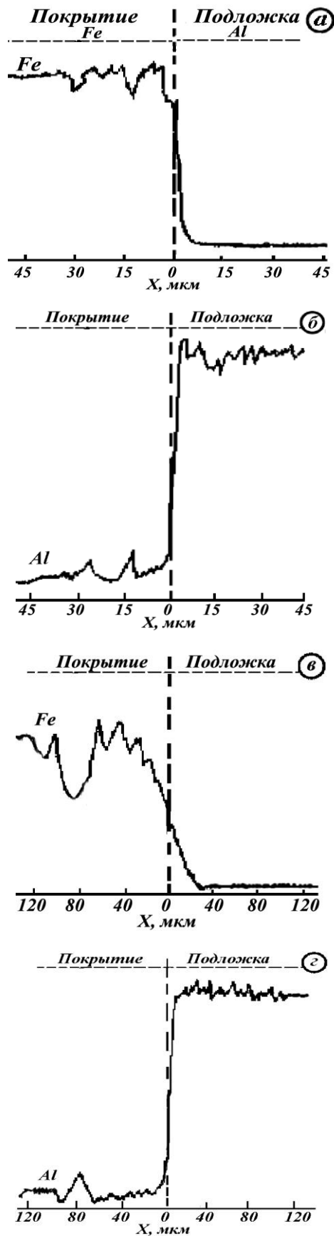
Рис. 1. Концентрационные кривые распределения железа (а, в) и алюминия (б, г) в покрытии после ЭИЛ с энергией разряда 0.3 Дж (а, в) и 6,4 (б, г).
