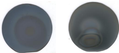
Рис. 1. Фотографии образцов №1 и №2 с выраженной зональной структурой.
